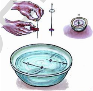
شکل 2- سوئیوں کو مقناطیس میں تبدیل کر کے پانی پر تیرانا
